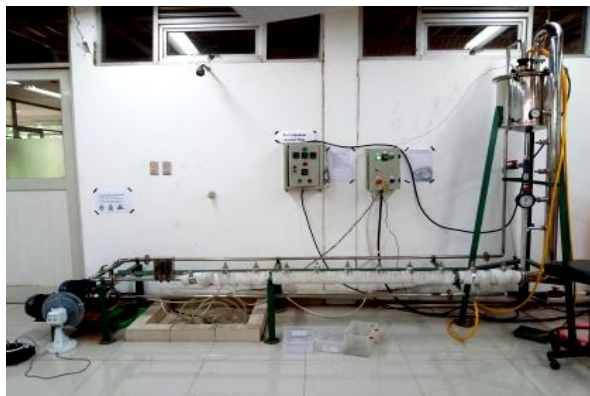
Gambar 1. Alat simulasi uji laju korosi pipa
