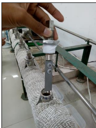
Gambar 2. Pemasangan spesimen pada holder
