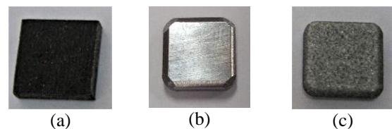
Gambar 1. (a) Substrat baja karbon rendah sebelum dipoles, (b) Substrat baja karbon rendah setelah dipoles dan dibentuk (c) Substrat baja karbon rendah setelah dilapisi
