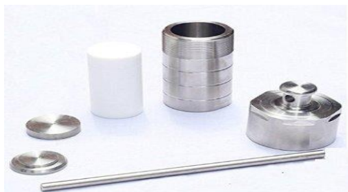
Gambar 1. Reaktor autoclave dari baja dengan container teflon di dalamnya
