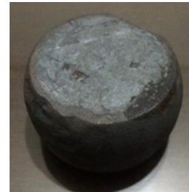
Gambar 3. Foto visual baja laterit paduan NiCrMn setelah proses tempa panas dengan reduksi 31,72%
