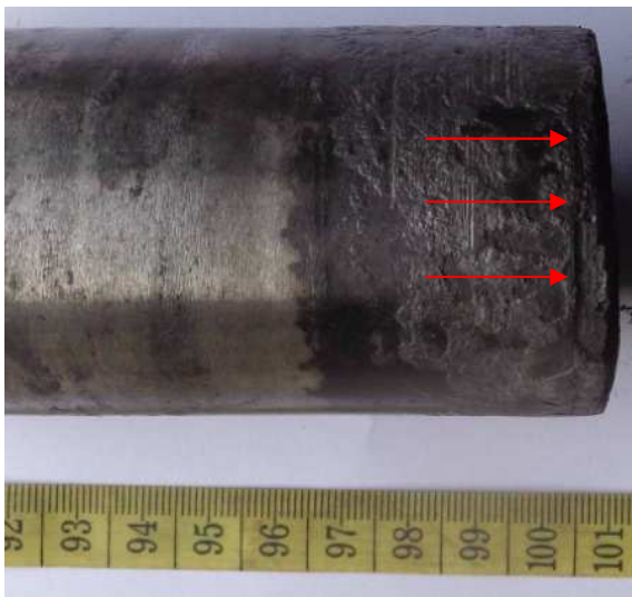
Gambar 5. Stem yang patah teramati adanya fillet
