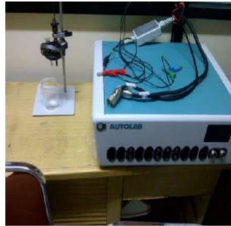
Gambar 7. Alat uji korosi metode polarisasi AUTOLAB
