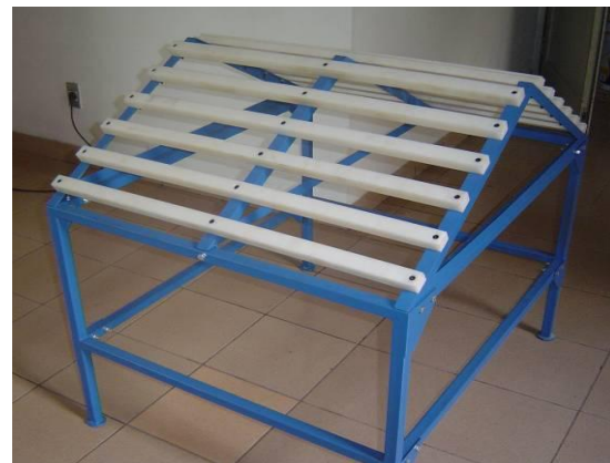
Gambar 6. Rak percobaan sebagai tempat penyimpanan pelat baja karbon ASTM A 36
