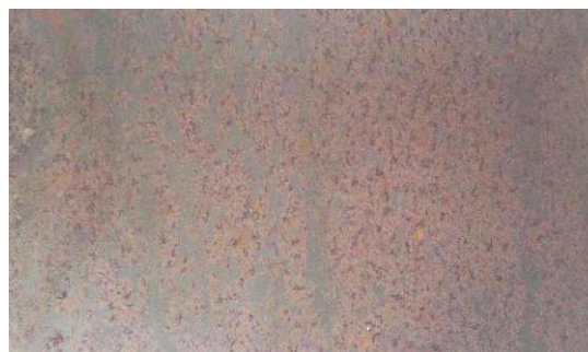
Gambar 4. Sampel penelitian berupa pelat baja karbon ASTM A 36
