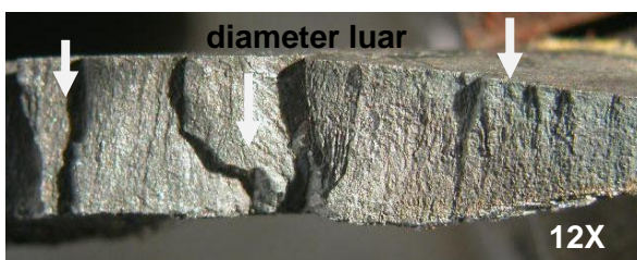
Gambar 6. Foto makro mengalami retak dalam bentuk circumferential (melingkar)
