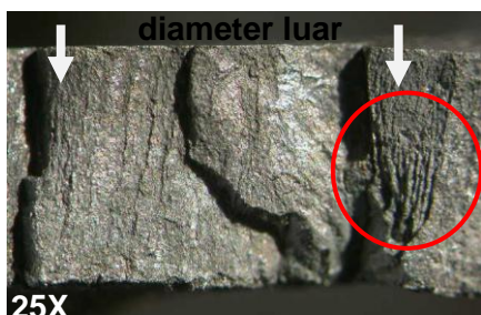
Gambar 7. Alur patah pipa radiant section di posisi ekspand no. 65 diawali dari diameter luar
