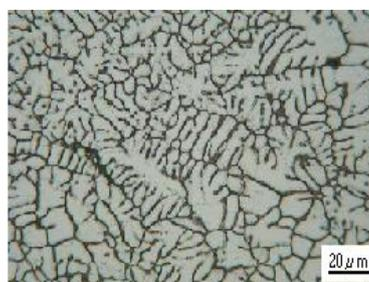
**Gambar 8.** Struktur mikro paduan Al-6,2%Mg. Etsa : Keller Reagent
