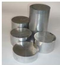
**Gambar 4.** Komposit matrik logam hasil proses pembubutan
