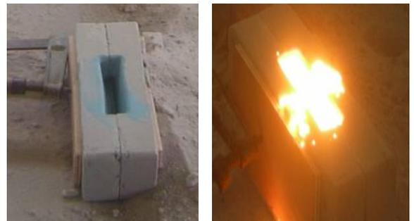
**Gambar 1.** Cetakan pasir CO<sub>2</sub> proses yang digunakan dalam pengecoran dan coran baja paduan sintetis
