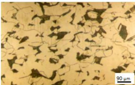
**Gambar 14.** Foto strukturmikro baja karbon A192 (Etsa Nital)
