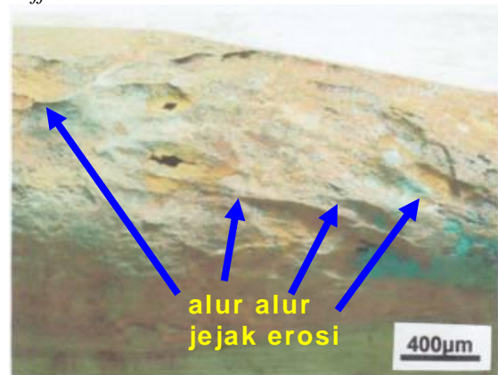
Gambar 5. Lubang dan jejak erosi pada pipa baffle di lokasi 1
