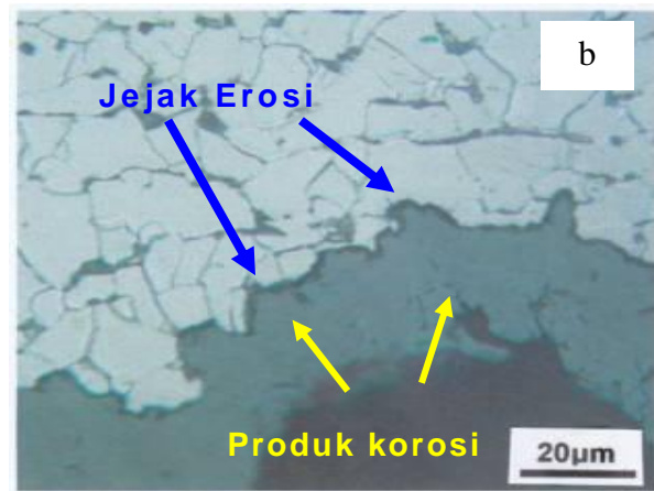
Gambar 12. Perbesaran penampang melintang pipa baffle (di lokasi 2). Etsa Nital 2%
