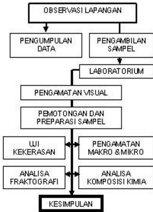
Gambar 1. Skema alur penelitian kegagalan poros roda belakang kendaraan
