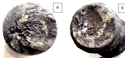
Gambar 4. Permukaan patahan stem bagian atas (sampel A) dan bagian bawah (sampel B)
