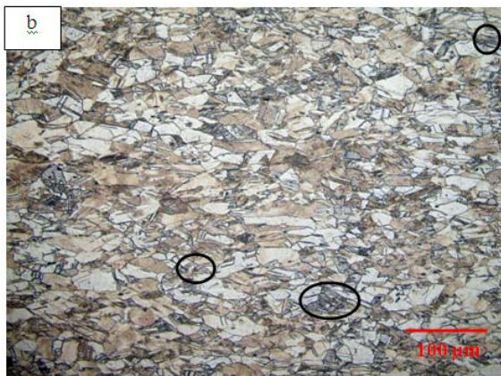
Gambar 8. Foto mikrostruktur untuk paduan Cu-Zn 70/30 hasil warm roll pada T= 500 °C dengan deformasi 38,7% (a) Bagian tepi, (b) Bagian tengah. Etsa 10% \text{FeCl}_3
