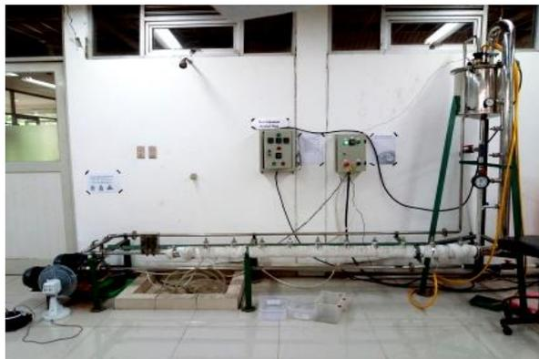
Gambar 1. Alat simulasi uji laju korosi pipa
