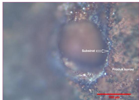
Gambar 11. Hasil foto metalografi serbuk produk korosi pada permukaan baja karbon
