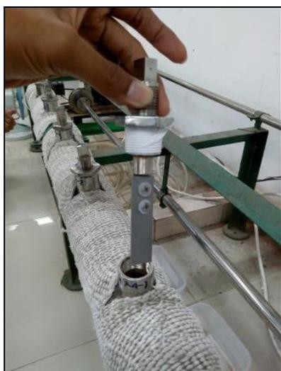
Gambar 2. Pemasangan spesimen pada holder
