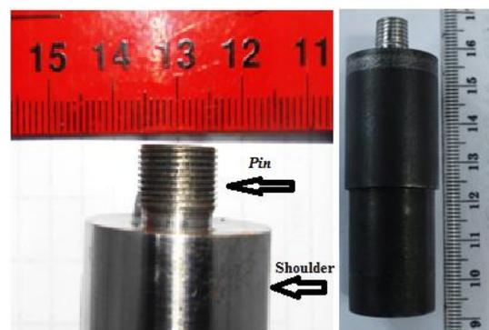
Gambar 3. Desain perkakas proses FSW pada aluminium 5052-H32
