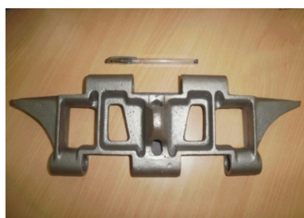
Gambar 2. Prototipe produk cor tapak rantai
