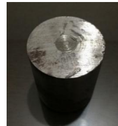
Gambar 1. Foto visual baja laterit paduan NiCrMn dengan ukuran 47 x 47 x 49 mm sebagai sampel awal proses tempa panas
