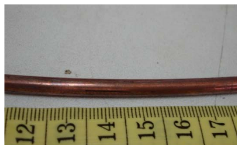
Gambar 2. Elektroda las dengan pelapis tembaga untuk las busur rendam (SAW)
