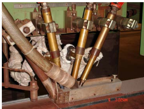
Gambar 1. Mesin las busur rendam atau submerged arc welding (SAW) yang dipergunakan pada proses pembuatan pipa
