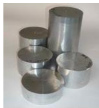
Gambar 4. Komposit matrik logam hasil proses pembubutan
