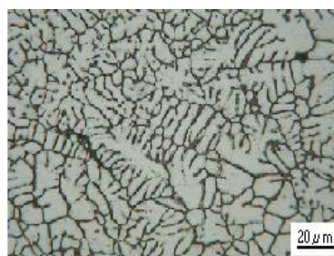
Gambar 8. Struktur mikro paduan Al-6,2%Mg. Etsa : Keller Reagent
