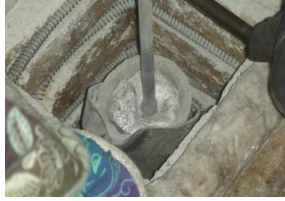
Gambar 2. Proses pengadukan komposit matrik logam dengan penguat Al_2O_{3(p)}
