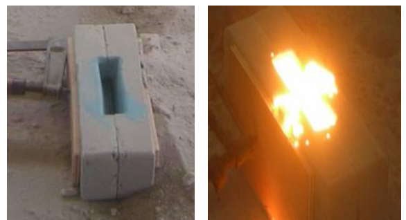
Gambar 1. Cetakan pasir CO 2 proses yang digunakan dalam pengecoran dan coran baja paduan sintetis
