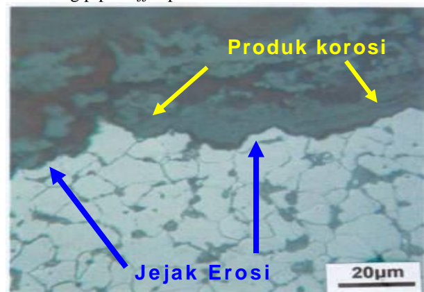
Gambar 13. (a) Struktur mikro penampang melintang pipa baffle pada lokasi 2. (b) Perbesaran dari (a), terlihat adanya butir yang terpotong akibat erosi. Etsa Nital 2%
