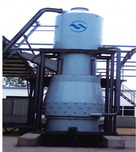
Gambar 10. Kupola udara panas di China<sup>[11]</sup>
