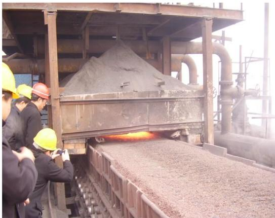
Gambar 1. Proses pembuatan sinter<sup>[3]</sup>
