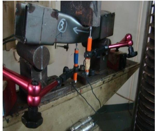
**Gambar 10.** Foto set up/ sistem uji dan mekanisme kerusakan akibat interaksi beban uji tekan memusat dan momen lentur
