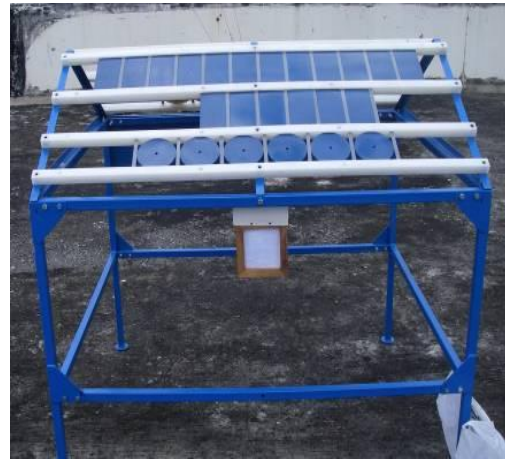
Gambar 12. Pelat baja karbon rendah ASTM A36 hasil coating poliuretan tersusun dalam rak penelitian di lapangan
