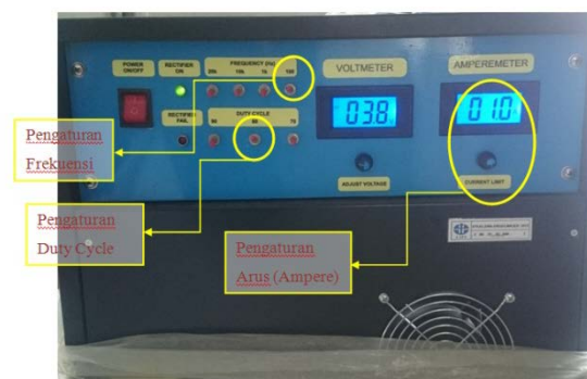
Gambar 1. Display rectifier selama proses pelapisan
