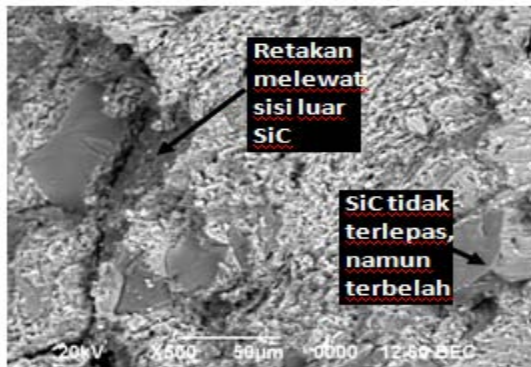
Gambar 8. Alur retakan pada komposit AC8A/SiCp
