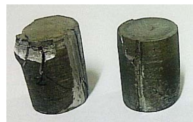
Gambar 6. Spesimen setelah Uji Tekan (a) AC8A hot press (b) AC8A/SiCp hot press
