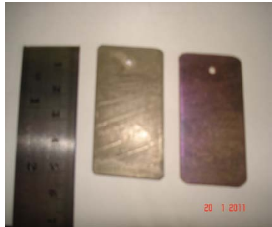
Gambar 3. Sampel sebelum dan sesudah diberi lapisan Ni-Mo
