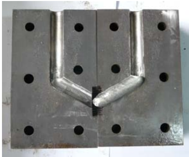
Gambar 3. Dies yang digunakan dalam pengerjaan ECAP
