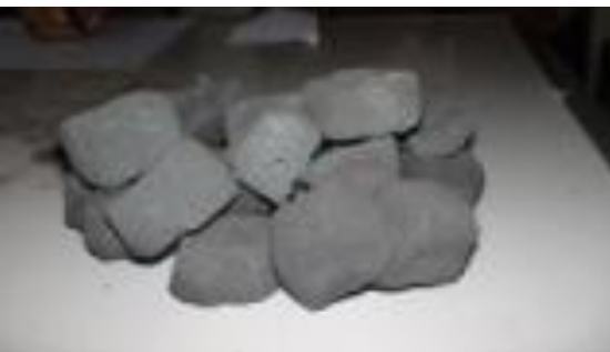
Gambar 4. (a) Sponge perekat bentonit T = 1150 °C, 60 menit, (b) Proses pengulangan pada (a)
