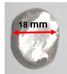
Gambar 2. Ingot paduan Co-35Cr-5Mo-xMn ( x=0-1 % berat) hasil peleburan dengan tungku busur listrik
