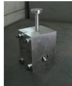
Gambar 1. Susunan alat ECAP yang memiliki lubang dalam membentuk sudut 120°
