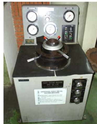
Gambar 3. Alat USM ( universal sheet metal ) untuk pengujian mampu bentuk deep drawing
